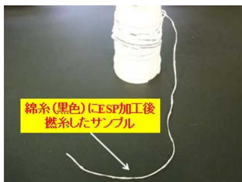
図4 エレクトロスピンニング表面加工糸
