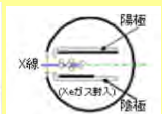
図2 マルチチェンバー型X線検出器の概略 (X線と衝突したXeガスが電子とイオンに分離して電極間に電流が流れることでX線を検出する)
