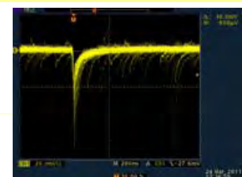
図7 \mu -PIC検出器による入射X線の検出信号の観測
