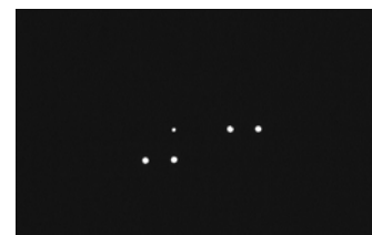
直径10 \mu mと20 \mu mの穴加工実験(SUS304)
