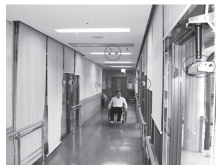
図2 実証実験で設置した見守りゲート (丸印の位置にカメラが設置されている)
